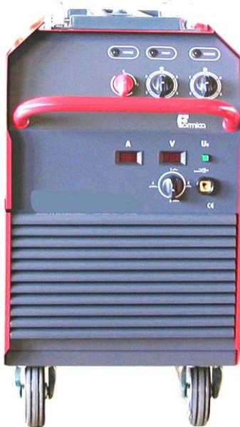
**ForMIG 420 FWS, resp. ForMIG 520 FWS** – prevedenie s externým podávačom drôtu umiestneného na stojane, resp. ramene s možnosťou otáčania podávača s ramenom okolo osi stojana s možnosťou naklápania vo vertikálnej osi v zadefinovanom rozsahu, čo umožňuje väčší akčný rádius dosahu horáka k miestu zvaru (S-stand – stojan, F- feed/samostatný podávač, W – water/voda – integrované vodné chladenie horáka v zdroji zváračky),
