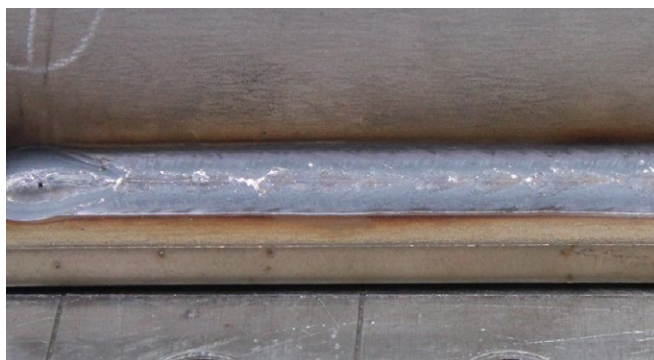
Přední strana: Menší pronikání tepla při forceArc puls®, menší oxidace povrchu, tím lepší vzhled
