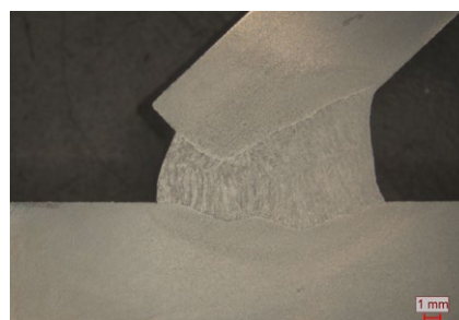
Tloušťka stěny nosníku 10 mm, úhel otevření svaru 35°
