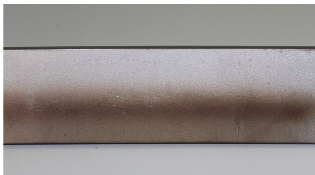
Zadní strana: Malé pronikání tepla při forceArc puls®, menší oxidace povrchu
