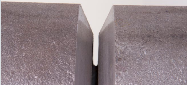
Příprava svařování kořene na trubce, úhel otevření svaru, 60° se vzduchovou mezerou 3 mm
