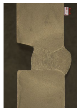
Tloušťka plechu 10 mm, faseta jednostranně 15 stupňů, vzduchová mezera 4 mm
