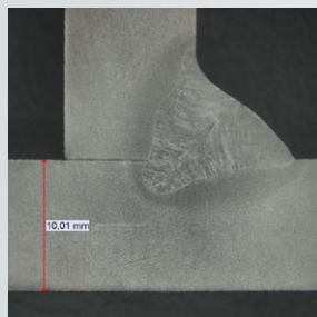
Délka volného drátu 12 mm
